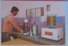
SAND SEVER SAND RAMMER PERMEABILITY TESTER.
